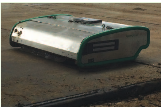
Photo 21 : Robot racler et aspirateur de lisier pour les aires de tapis.
