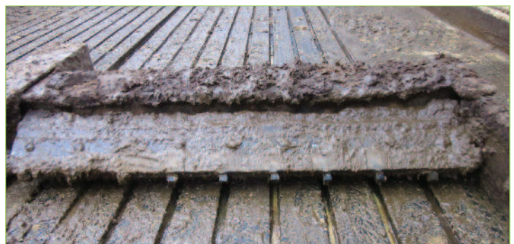
Photo 18 : Racleur à peignes en caoutchouc sur tapis, pour une meilleure évacuation des souillures hors des rainures.
