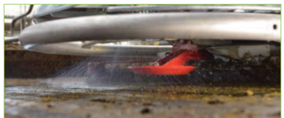
Photo 29 : Robot de raclage avec pulvérisation à l'avant.
