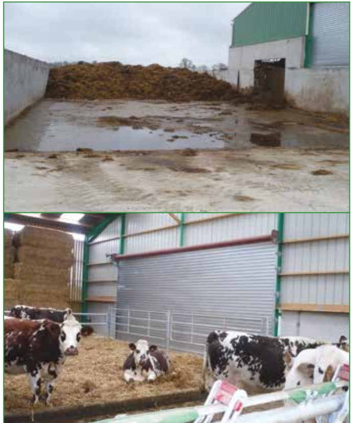
Photos 35 et 36 : Un portail spécifique en lien avec une fumière en contrebas permet de curer efficacement et rapidement l'aire paillée. Le stockage du fumier est géré dans un 2 ème temps, portail fermé.
