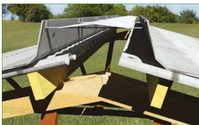
Figure 22 : Plan 3D de faîtière ouverte avec tôles pare-vent et pare-pluie.
