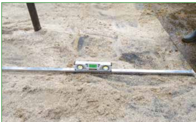
Photo 51 : Mesure de la pente des logettes avec tapis et farine de paille, en conduite lisier. Attention aux pentes excessives (> 4 %).
